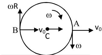
For no slipping  $v_0 = \omega R$
